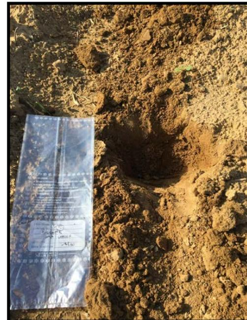
All'interno di ogni plot è stato effettuato un mini-pit ed è stato campionato l'orizzonte più superficiale Ap (0-10 cm).
