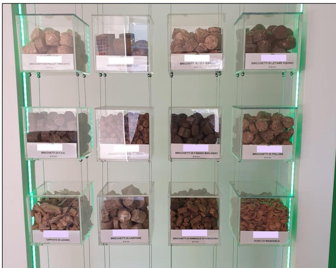
Figura 5. Biomasse legnose valorizzabili tramite il processo di pirogassificazione.
